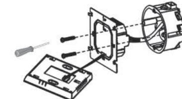
4. Приложите основную панель под углом 30° на 2 верхних защелки, надавите на 2 нижних угла до фиксации нижних защелок, установка закончена.
