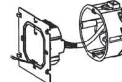
3. Соедините заднюю панель и крышку передней панели вставив в щели и сдвинув.
