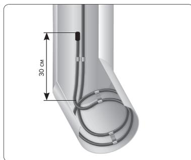
Рис 8. Схема укладки кабеля внизу сливной воронки
