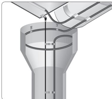
Рис 7. Схема укладки кабеля наверху сливной воронки
