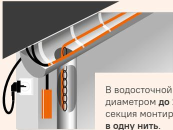
В водосточной трубе диаметром до 10 см секция монтируется в одну нить.
