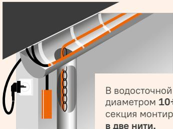
В водосточной трубе диаметром 10÷15 см секция монтируется в две нити.
