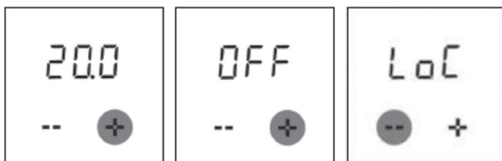
Терморегулятор ДЕВИ Room можно включить и выключить вручную.
