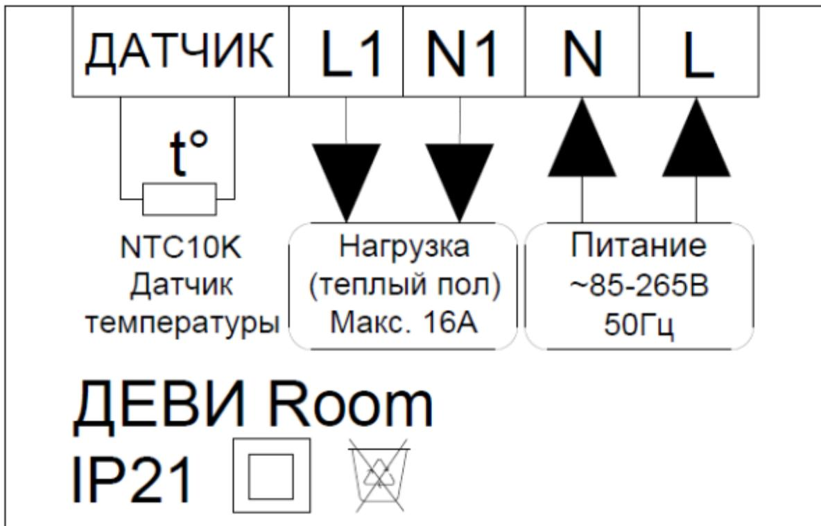
Схема электрических подключений, присутствующая на корпусе терморегулятора:
