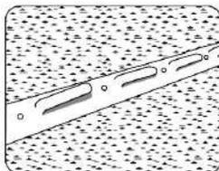
Используя крепеж (гвозди, дюбели и т. п.), зафиксируйте монтажную ленту на черновом бетонном основании. Они крепятся в том месте, где будут заканчиваться петли нагревательной секции и с интервалом 50-100 см для крепления секции в средней части. Расположите их параллельно друг другу. За счет этого достигается ровная параллельная укладка кабеля.
