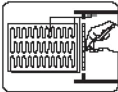
Определить зону обогрева открытых площадей в соответствии с выбранной длиной нагревательного кабеля, сделать схему укладки в масштабе и прорисовать раскладку нагревательного кабеля с учетом шага укладки. На ступенях кабель необходимо укладывать с меньшим шагом.
