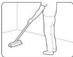
Выверните поверхность перед укладкой нагревательного кабеля. Далее необходимо ее тщательно очистить, убрать с поверхности все острые или заостренные предметы. В случае, если имеются на обогреваемой поверхности термокомпенсационные швы, нагревательный кабель должен быть расположен так, чтобы он не проходил через шов. Сделайте разметку укладки нагревательного кабеля.
