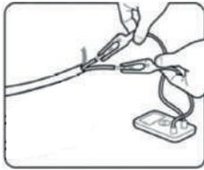
Измерьте и запишите исходное сопротивление нагревательного кабеля. Внесите измеренное значение сопротивления в гарантийный талон. Данные должны соответствовать заводским параметрам в пределах допустимого отклонения + 10/- 5%, указанного в паспортных данных (измерение сопротивления необходимо производить при 20 °С).
