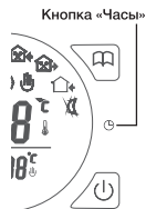
Рисунок 6. Переход в режим установки времени
