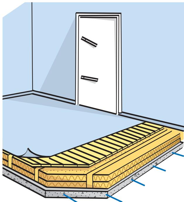
Пример использования нагревательного кабеля в конструкции пола морозильной камеры.
