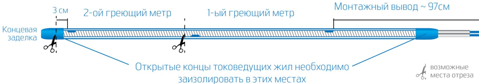
После обрезки необходимо произвести изоляцию оголенных концов кабеля, смонтировав на один конец концевую заделку, а на другой монтажный вывод.
