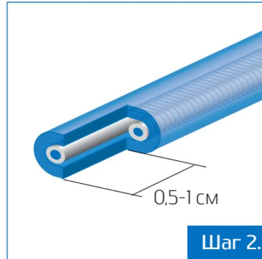
Для предотвращения замыкания одну из токоведущих жил обрезать, отступая от края примерно 0,5-1 см.
