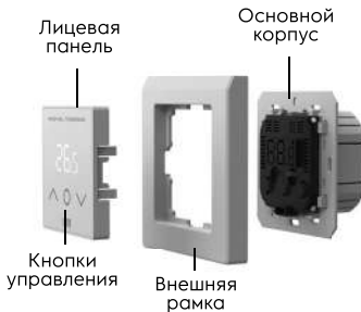
Рис. 3. Устройство терморегулятора
