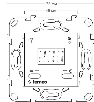
Рисунок 1. Габаритные размеры
