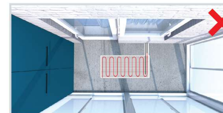
Неправильная укладка нагревательного мата
