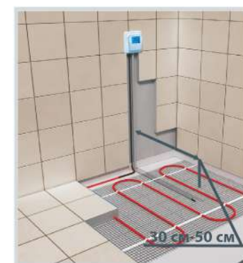
Схема укладки датчика температуры в гофрированной трубке
