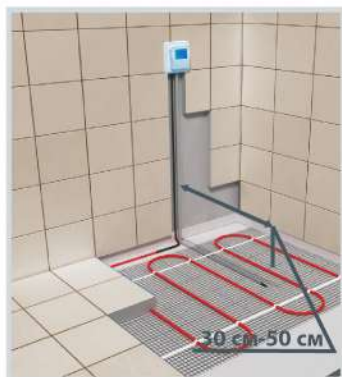
Схема укладки датчика температуры в гофрированной трубке
